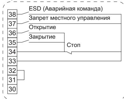
Подключение для управления подачей напряжения
