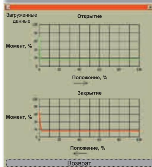
С помощью постоянного отслеживания данных значений и анализа их изменений с течением времени, пользователь может выработать закономерности для прогнозирования технического обслуживания.
